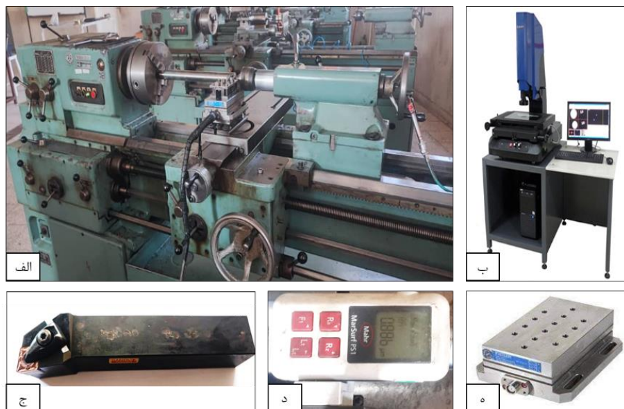
شکل ۲ تجهیزات مورد استفاده در آزمایش‌ها (الف) دستگاه تراش (ب) vmm (ج) هولدر (د) زبری سنج (ه) نیروسنج
