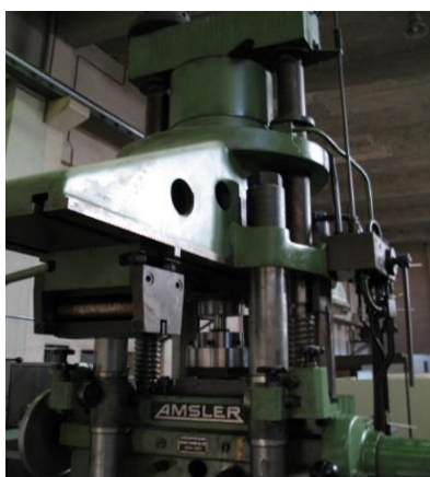
شکل ۲ مجموعه پرس هیدرولیک مورد استفاده در آزمایش‌ها تجربی و مجموعه قالب نصب شده بر روی آن
