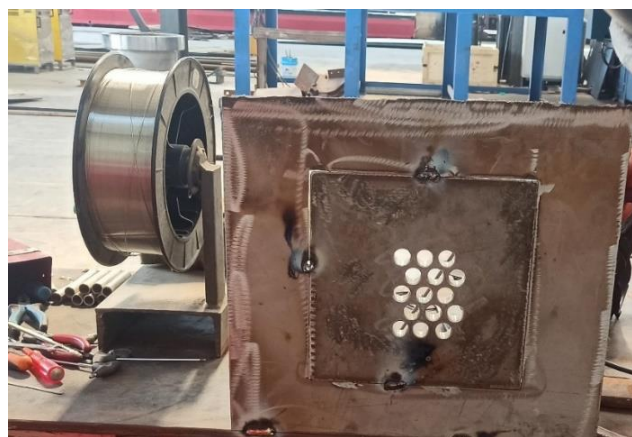
شکل ۱ نمونه اتصال تیوب-به-تیوب شیت با آرایش مثلثی ساخته شده
