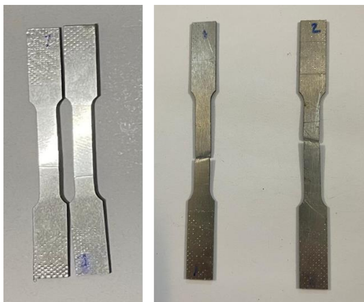
شکل ۱۲ الگوهای شکست نمونه‌ها پس از تست کشش تک‌محوره: الف) ورق آلومینیوم؛ ب) ورق هایلایت
