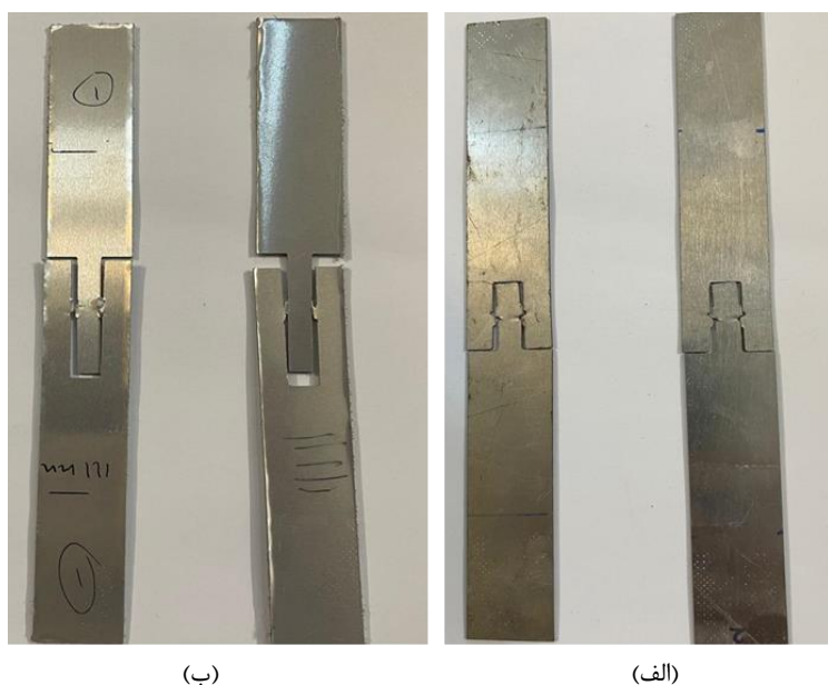
شکل ۸ الگوهای شکست نمونه‌ها پس از تست برش درون صفحه: الف) ورق آلومینیوم؛ ب) ورق هایلایت
