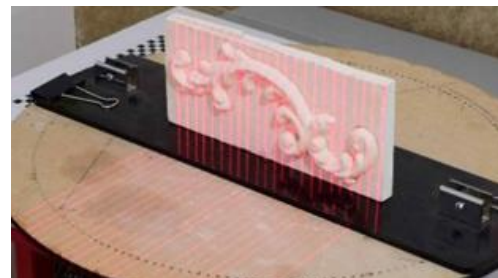
شکل ۴ نمایی از قطعه در حال تصویربرداری (سمت راست) و ابر نقاط خروجی اسکن (سمت چپ)
