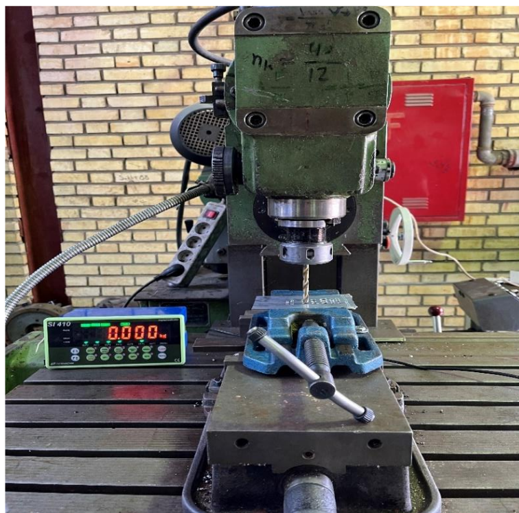
شکل ۲ نمونه در حین انجام سوراخکاری و ثبت نیرو با استفاده از نیروسنج
