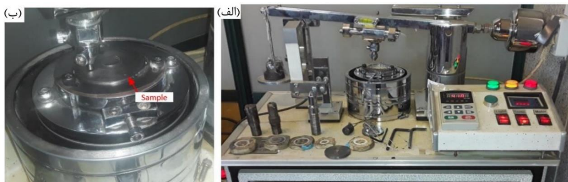
شکل ۳ (الف) دستگاه تست سایش پین بر روی دیسک و (ب) انجام آزمون سایش بر روی نمونه
