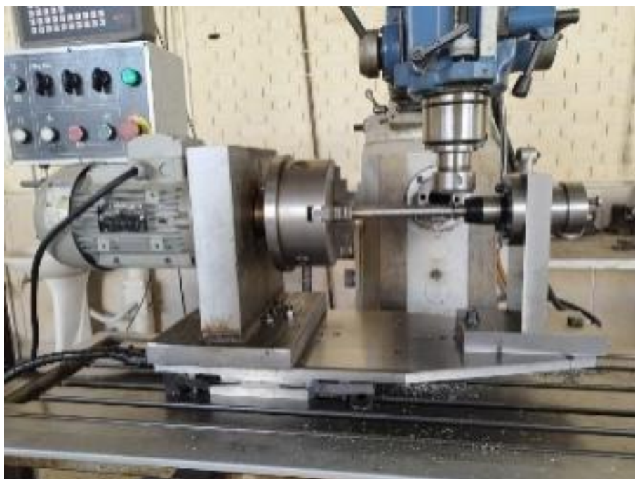
شکل ۳ نحوه اتصال مکانیسم تراش ساخته‌شده بر روی میز فرز
