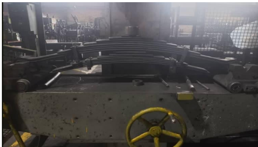
شکل ۱ آزمون محاسبه ضریب فنریت فنر تخت
