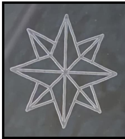
شکل ۳ نمونه ورق PMMA پس از حکاکی کانال های میکرو با مته ۱ میلی متری
