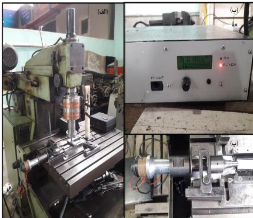
شکل ۳ آزمایش جوشکاری با کمک امواج فراصوت (جانبی): الف) انجام جوش RFSSW (ب) ژنراتور فراصوت (پ) سر نوسان فراصوت شامل هورن و مبدل فراصوت در موقعیت ساعت ۹
