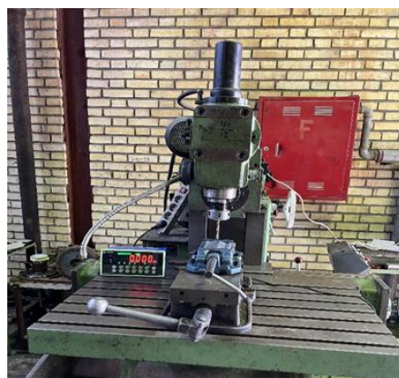
شکل ۱ الف) دستگاه فرز یونیورسال و ب) نمونه بعد از انجام سوراخ کاری
