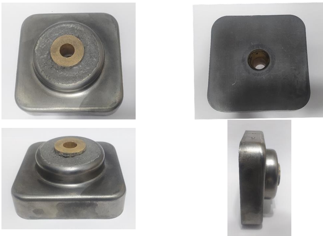
شکل ۱ تصویری از زوایای مختلف از قطعه نازل تاندیش ساخت کشور چین
