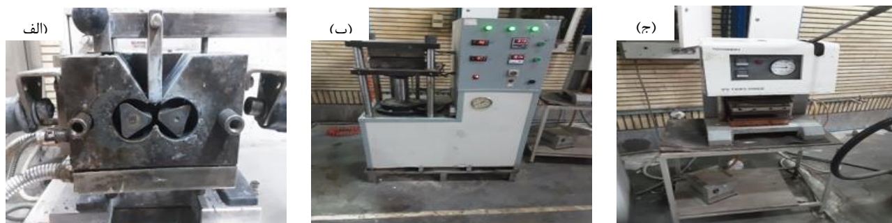
شکل ۱ وسایل مورد استفاده در فرایند ساخت: (الف) میکسر داخلی، (ب) پرس داغ و (ج) پرس سرد
