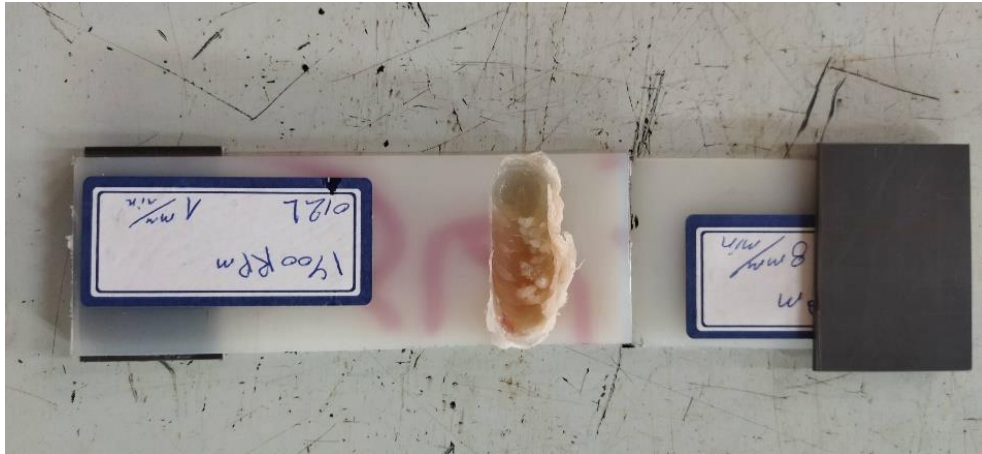
شکل ۲ نمونه جوشکاری شده قبل از تست کشش
