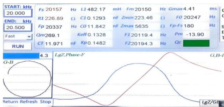
شکل ۳ اندازه‌گیری فرکانس تشدید ابزار سوراخ‌کاری ارتعاشی
