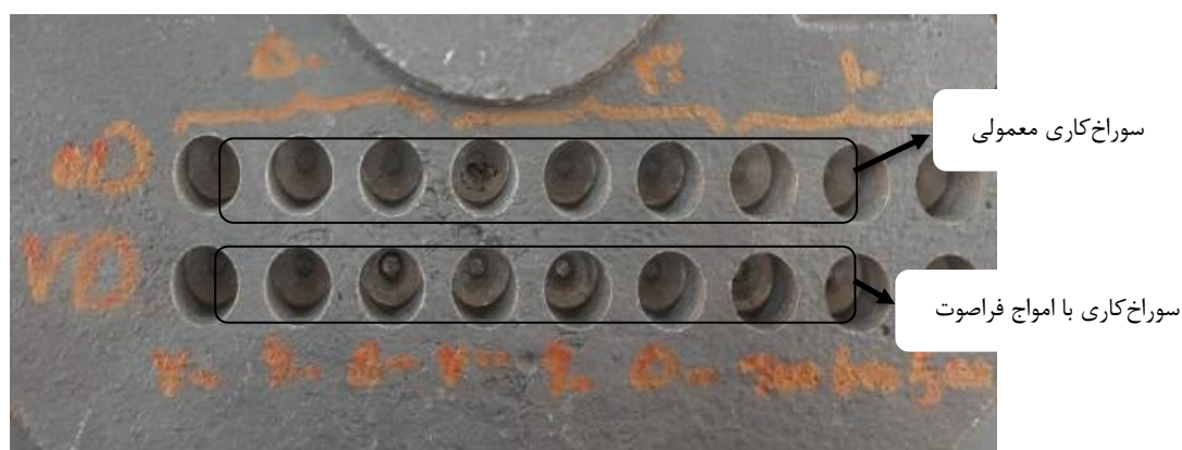
شکل ۵ سوراخ‌های ایجاد شده روی چدن خاکستری GG20
