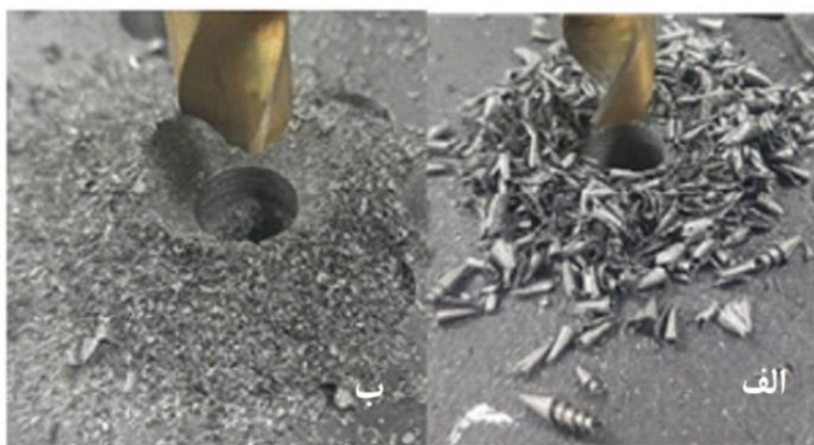
شکل ۹ مقایسه نوع و اندازه براده در الف) سوراخ‌کاری معمولی و ب) سوراخ‌کاری ارتعاشی
