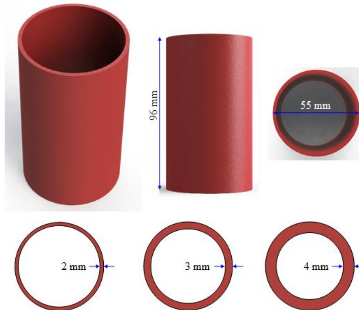
شکل ۱ لوله‌های جدار نازک طراحی شده در SolidWorks با ضخامت‌های ۲، ۳ و ۴ میلی‌متر
