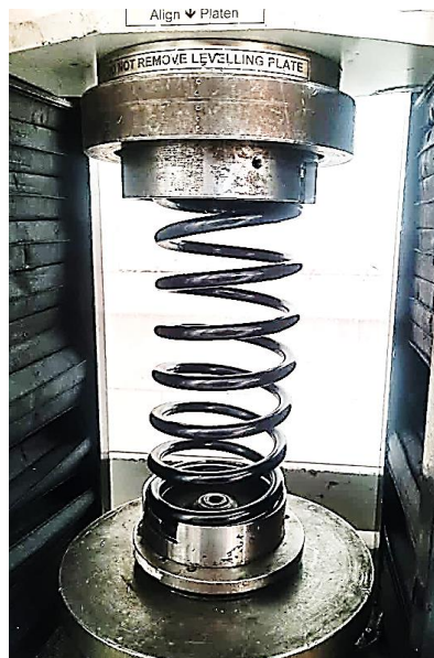
شکل ۴ ستاپ آزمون فنر سیستم تعلیق، دستگاه IST-LT4 مستقر در آزمایشگاه کنترل کیفیت شرکت فنرلول ایران، مجهز به نیروسنج و حسگر تغییر طول
