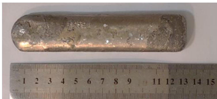
شکل ۱ تصویر شمش آلیاژ X750 تحقیق حاضر
