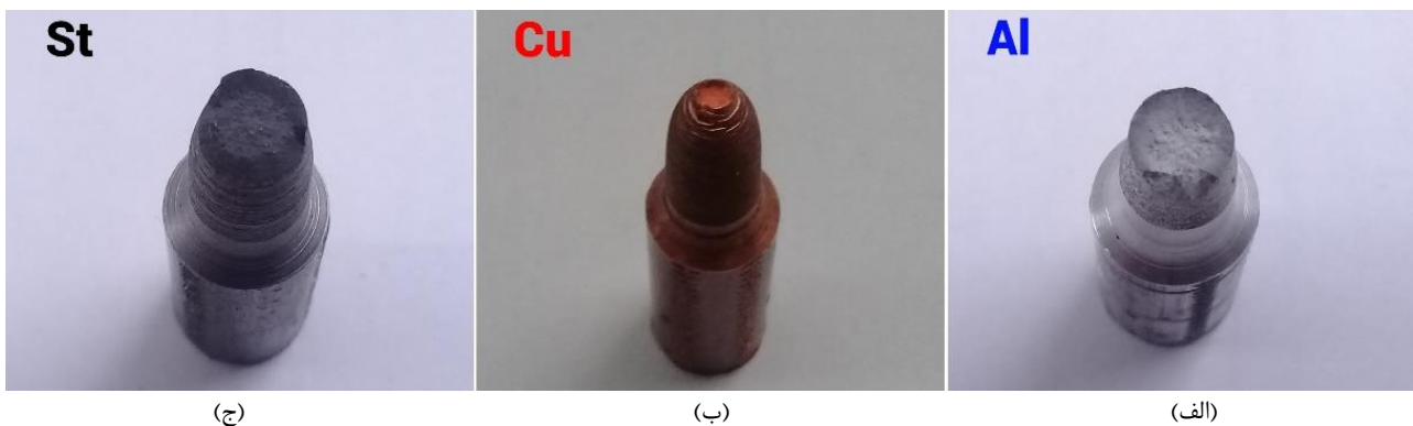
شکل ۹ مقطع شکست میلگردهای فلز پایه پس از آزمون کشش
