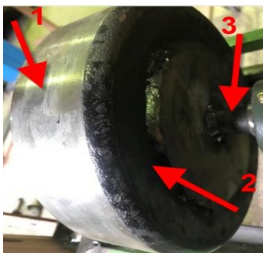
شکل ۷ غلتک طراحی شده به عنوان نشیمنگاه چرخ (زمین)
