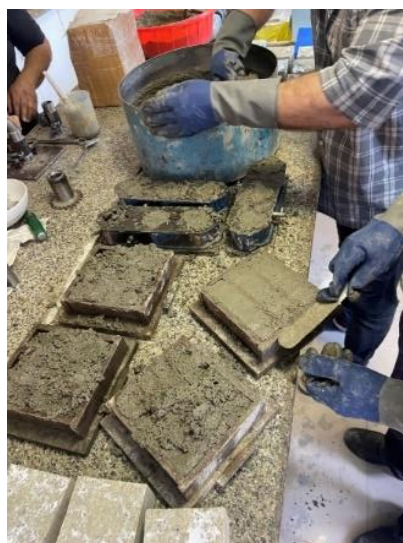
شکل ۱ قالب‌گیری نمونه‌های ملات
