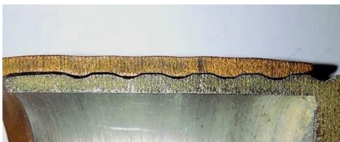
شکل ۸ الف) نمونه دو لایه قبل و بعد از فلوفرمینگ، ب) نحوه شکل‌گیری شیارهای لوله مسی
