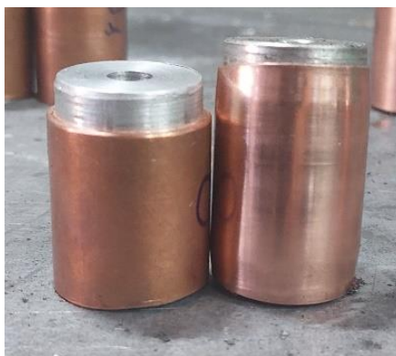
شکل ۶ لوله تولید شده دو لایه به روش فلوفرمینگ
