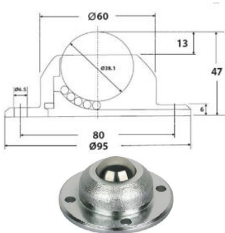
شکل ۵ سوار شدن قطعات روی دستگاه تراش و ابعاد بلبرینگ استفاده شده به عنوان ابزار فلوفرمینگ
