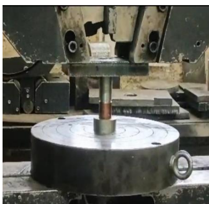
شکل ۹ نحوه قرارگیری سنبه و نگه‌دارنده روی دستگاه آزمون فشار Zwick-roell
