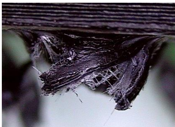
شکل ۲ تصاویر نواحی ورودی و خروجی مته در سوراخکاری بیوکامپوزیت PLA-Glass. (الف) ناحیه ورودی (ب) ناحیه خروجی
