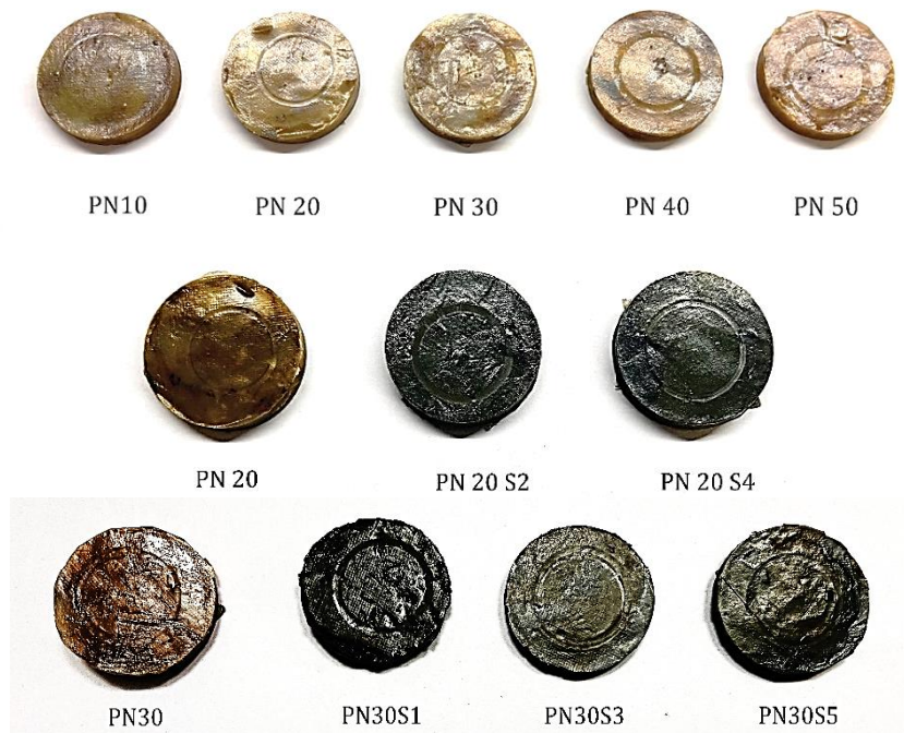
شکل ۵ تصاویر نمونه‌ها بعد از آزمون فرسایش
