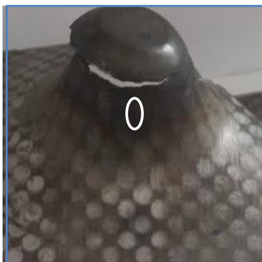
شکل ۱۱ محل اندازه‌گیری کرنش حادی در نمونه تغییر شکل یافته و گسیخته شده
