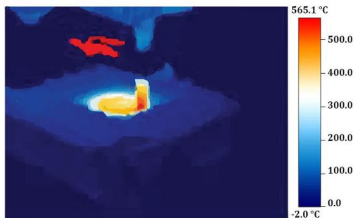
شکل ۳ ترموگرافی هم‌افزایی اثر ارتعاشات فراصوت و گرمای ژول
