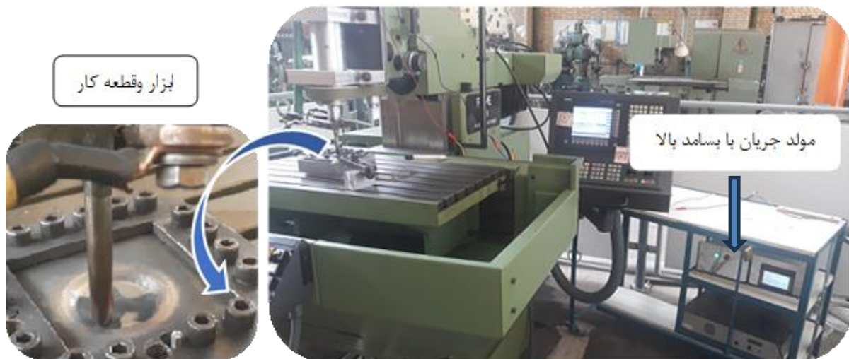
شکل ۲ نصب تجهیزات شکل‌دهی گرم نموی به کمک ارتعاشات فراصوت بر روی ماشین فرز کنترل عددی
