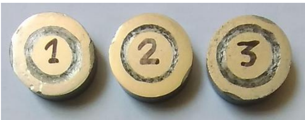
شکل ۳ تصویر نمونه‌ها پس از آزمون سایش را نشان می‌دهد. مطابق با شکل، نمونه ۱: AICAO، نمونه ۲: AICA1، نمونه ۳: AICA3.
