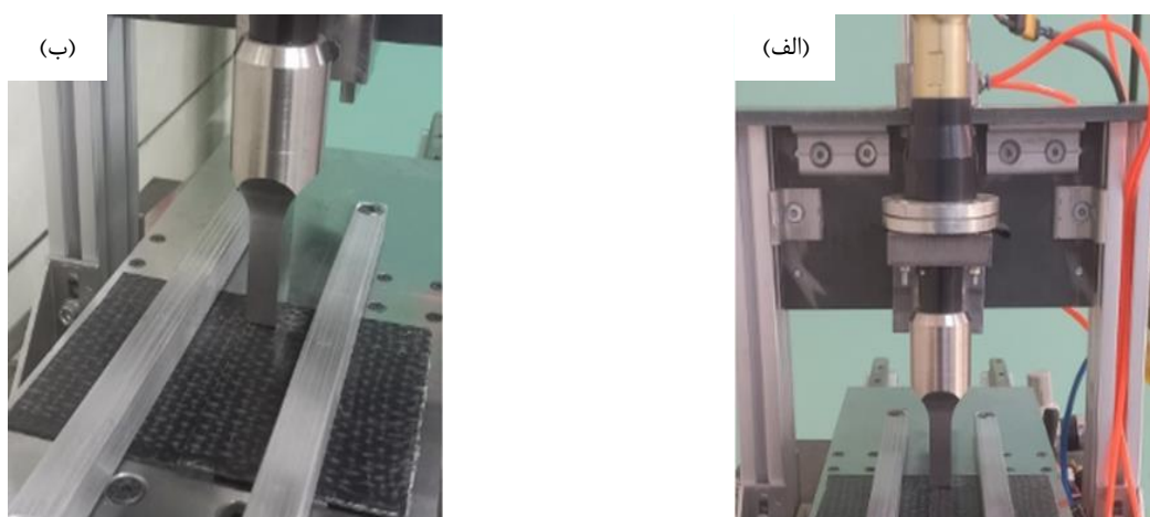
شکل ۲ چیدمان انجام آزمایش جوشکاری پیوسته فراصوتی مواد کامپوزیتی، (الف) کلگی فراصوتی، (ب) گیره بندی صفحات کامپوزیت بوسیله روبنده‌ها و تماس هورن (ابزار جوشکاری) با آن‌ها
