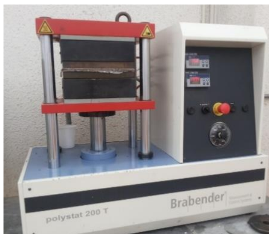
شکل ۱- نمایی از دستگاه پرس داغ مورد استفاده برای ساخت نمونه‌ها
