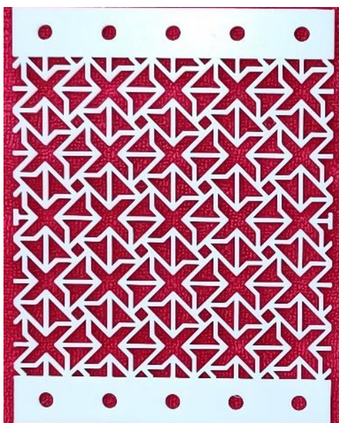
شکل ۴ نمونه تولید شده به وسیله پرینت سه بعدی با ساختار آگزتیک متشکل از سلول واحد نوین ارائه شده در تحقیق حاضر
