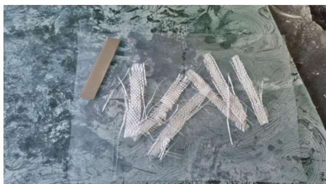
شکل ۴ کامپوزیت ساخته‌شده و مدل آماده‌شده مطابق استاندارد آزمون کشش
