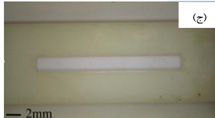
شکل ۴ الف) شماتیکی از نحوه قرارگیری اجزاء فرایند الکتروفرمینگ در نرم افزار کامسول، ب) مشخصات ابعادی قالب چاپ سه‌بعدی شده برای بخش صحت‌سنجی شبیه‌سازی عددی و ج) تصویر قالب تولید شده
