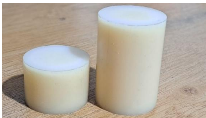
شکل ۱۰ نمونه استوانه‌های ABS برای اندازه‌گیری سرعت و ضرایب تضعیف به روش بازتابی
