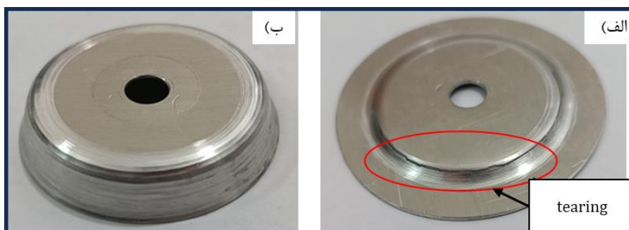
شکل ۷ الف) نمونه تولید شده با استراتژی S1 ب) نمونه تولید شده با استراتژی S2
