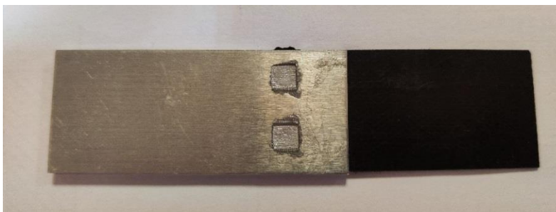
شکل ۸ سه لایه متصل شده به یکدیگر (دو لایه آلومینیوم و یک لایه کامپوزیت) مطابق استاندارد (ASTM D3528-96 (DOUBLE LAP SHEAR TEST) [۲۱] جهت انجام آزمون کشش
