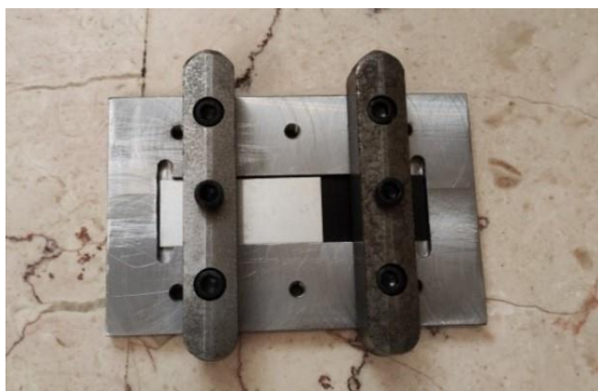
شکل ۶ نگهدارنده طراحی شده شامل پایه، لقمه و پیچ
