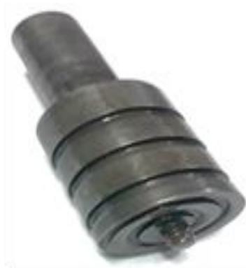
شکل ۱ ابزار پین مارپیچ و شانه طرح‌دار جوشکاری مورد استفاده
