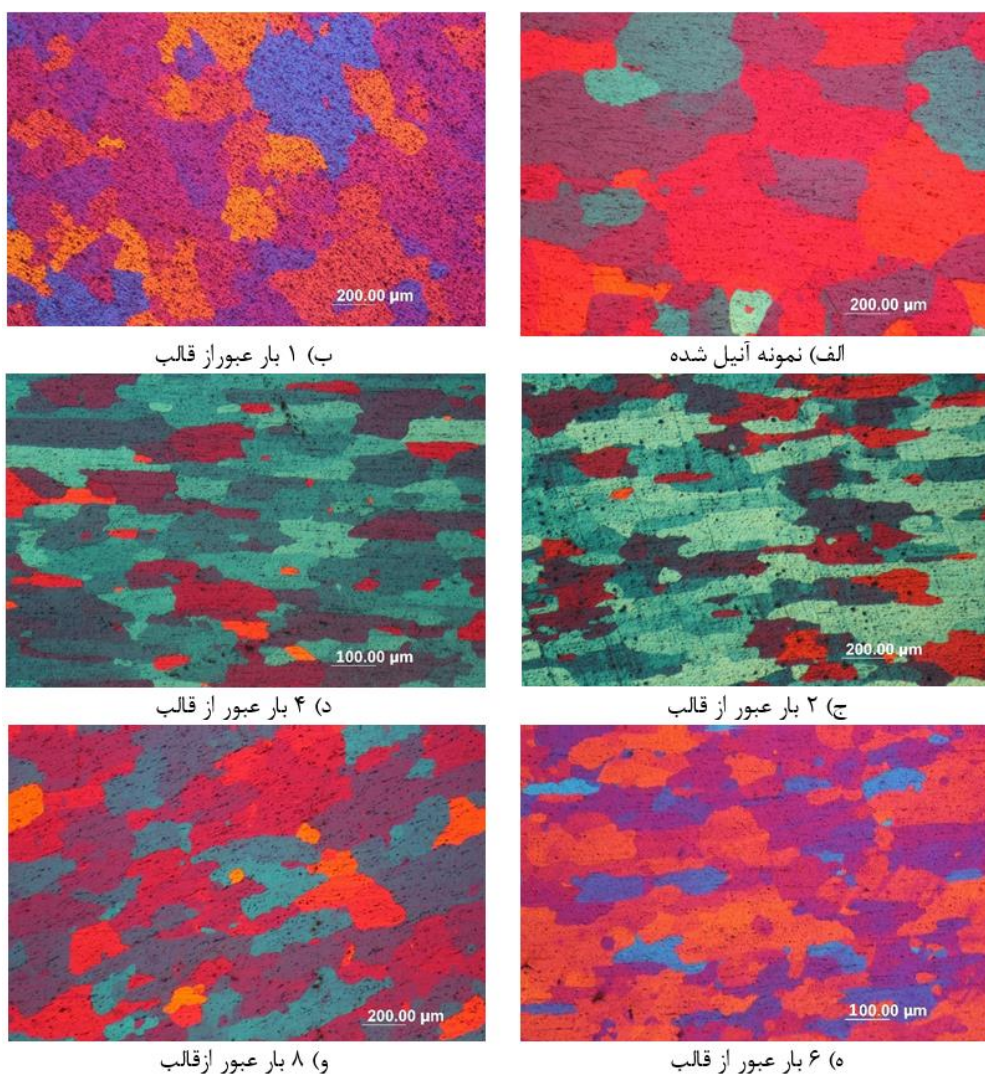
شکل ۴ تصاویر متالوگرافی نمونه‌ها در عبورهای مختلف از قالب CEE
