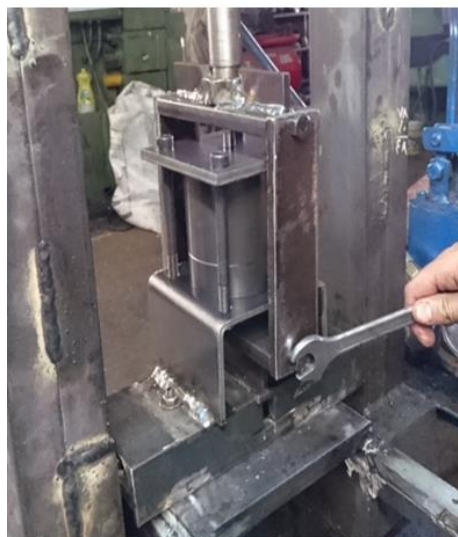
شکل ۳ نحوه اعمال پل بین سنبه بالایی و پایینی و شماتیک نحوه پرشدن قالب
