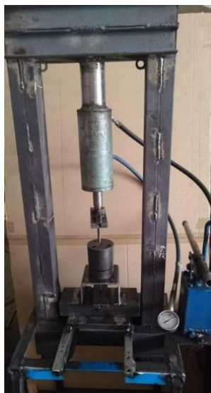
شکل ۲ نمایی از پرس ساخته شده به همراه قالب
