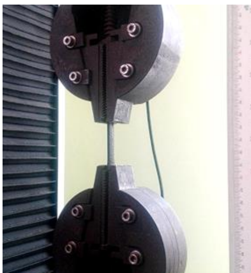
شکل ۶ تست کشش روی دستگاه STM-1
