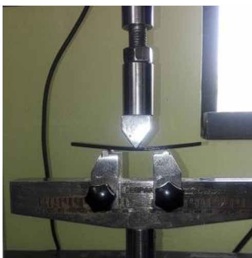
شکل ۷ تست خمش روی دستگاه STM-1
