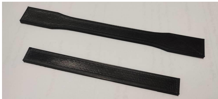
شکل ۵ نمونه‌های ساخته شده برای تست کششی و خمشی
