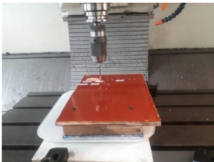
شکل ۲ تجهیزات فراهم شده جهت اندازه‌گیری نیروی عمودی
