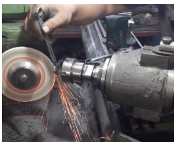
شکل ۱ دستگاه سنگ جونز-شیپ-من و فیکسچر ویژه جهت تیزکاری مته‌های مورد نیاز با زوایای آزاد و رأس مته مطلوب
