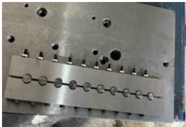
شکل ۱ فیکسچر عملیات حرارتی نمونه‌های استکانی فولادی (نمونه‌های ۱۰ میلی‌متر در درون فیکسچر)
