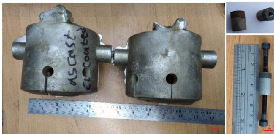
شکل ۵ الف) نمونه تهیه شده از بدنه سیلندر ساده‌سازی شده جهت آزمون کشش، ب) نمونه قطعات ریخته‌گری شده بدنه سیلندر ساده‌سازی شده پس از تهیه نمونه‌های آزمون کشش
