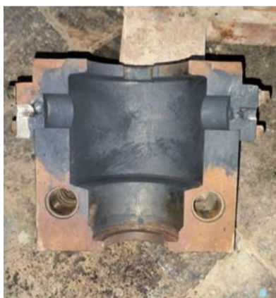
شکل ۲ قالب فولادی استفاده شده در ریخته‌گری
