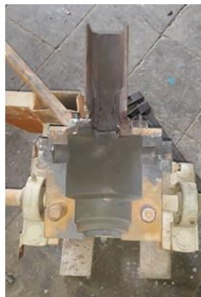
شکل ۲ قالب فولادی استفاده شده در ریخته‌گری
