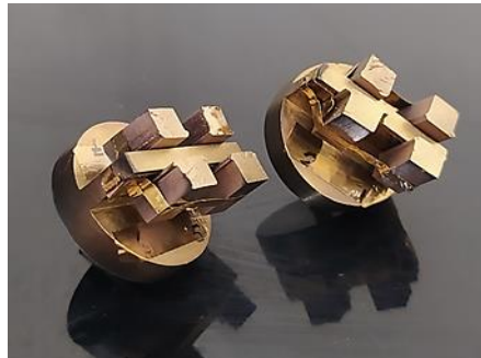
شکل ۵ پوشش‌دهی طلا سطوح شکست
