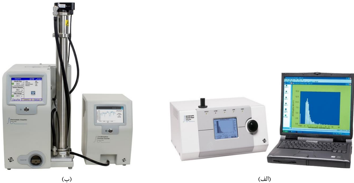
شکل ۱ سیستم‌های اندازه‌گیری ذرات و غبار در مقیاس های نانو و میکرو (ذرات ریز و فوق ریز)، الف) سیستم APS، مدل ۳۳۲۱ جهت اندازه‌گیری ذرات ریز و (ب) سیستم SMPS جهت اندازه‌گیری ذرات فوق ریز
