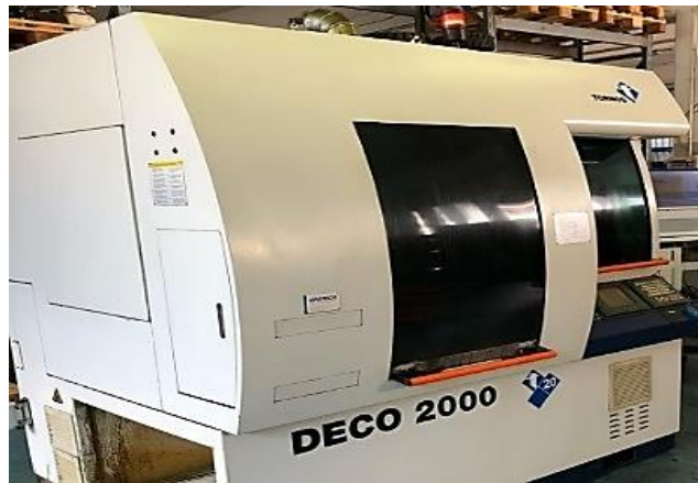
شکل ۳ ماشین ابزار مدل سوئیسی برند TORNOS DECO 2000 مورد استفاده در آزمایش‌های تجربی رزوه‌تراشی گردابی آلیاژ Ti6Al4V
