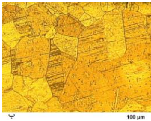
شکل ۱۰ ریزساختار مس C12200 الف) زمان ۶۰ دقیقه و دمای ۵۰۰ درجه سانتی‌گراد ب) زمان ۱۵۰ دقیقه و دمای ۹۰۰ درجه سانتی‌گراد
