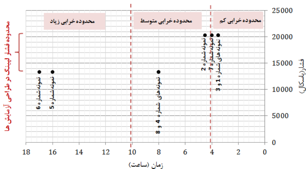
شکل ۵: زمان صرف شده در عملیات لپینگ برای نمونه‌های آنودایز نشده جهت مقایسه با نمونه‌های آنودایز شده
