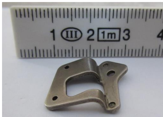
شکل ۱ محصول مورد نظر که از طریق فرایند MIM ساخته می‌شود (نمونه با یک لایه کروم پوشیده شده است)
