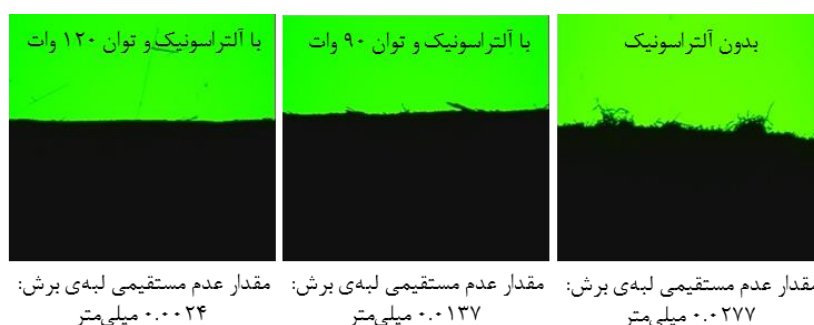
شکل ۷ مقایسه‌ی کیفیت لبه‌ی برش قطعه کار در برش با و بدون آلتراسونیک
