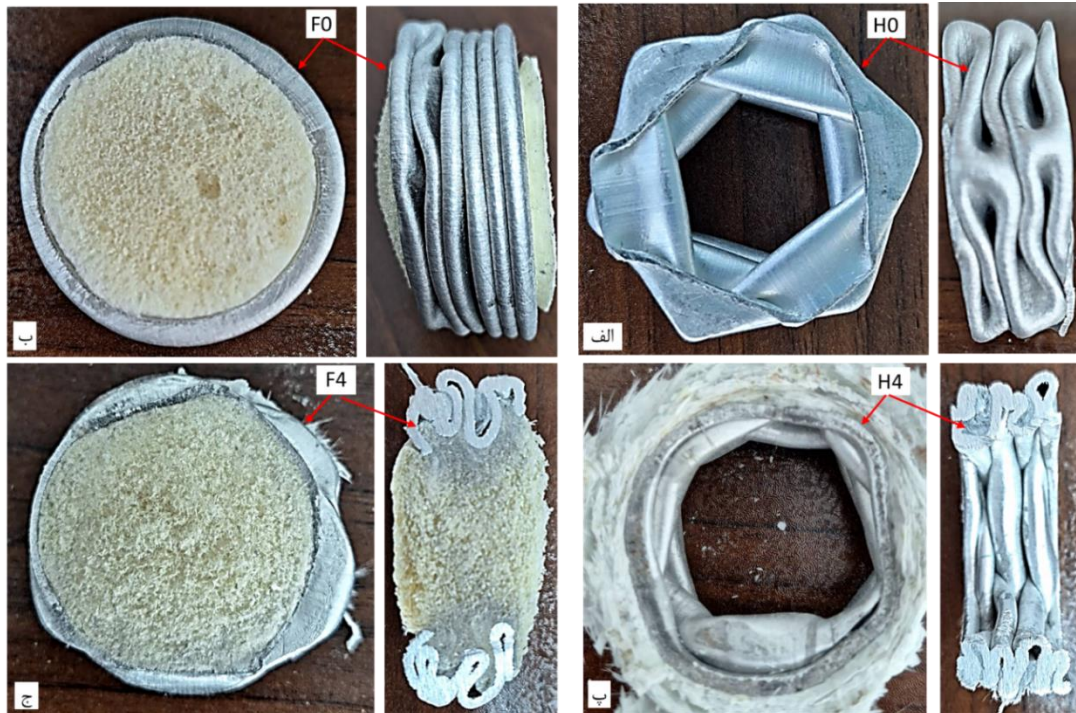
شکل ۹ مود تغییر شکل نمونه‌های مختلف تحت لهدگی: الف) لوله آلومینیومی توخالی و ب) توپر بدون لایه کامپوزیتی، پ) لوله هیبریدی توخالی و ج) توپر با لایه کامپوزیتی به ضخامت 1/75 میلی‌متر.
