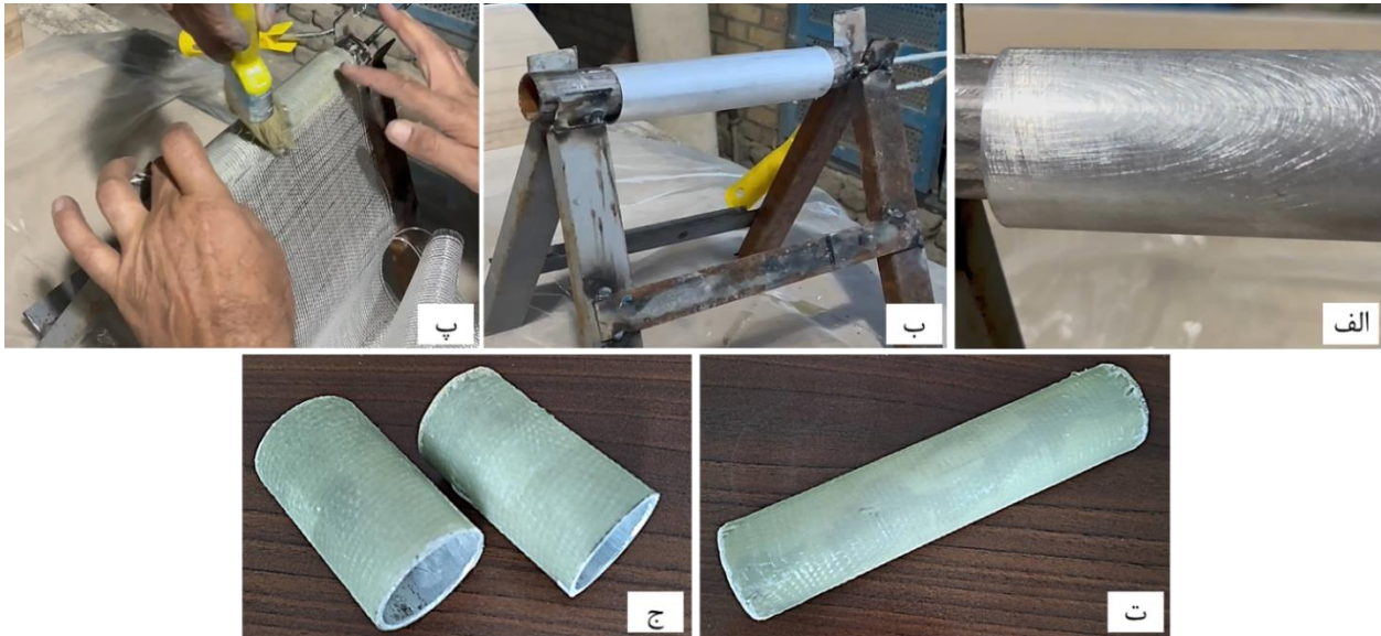
شکل ۱ مراحل ساخت نمونه‌ها، الف) زبرسازی سطح لوله آلومینیومی، ب) فیکسچر دوران لوله و الیاف پیچی، پ) آغشته‌سازی الیاف شیشه با رزین پلی‌استر، ت) لوله هیبریدی ساخته شده به طول ۲۰ سانتی‌متر و ج) دو نمونه ۸ سانتی‌متری با مشخصات کاملاً یکسان برای آزمون توخالی و پر شده با فوم
