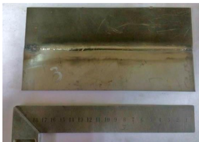
شکل ۳ نمایی از ورق‌های جوش داده شده
