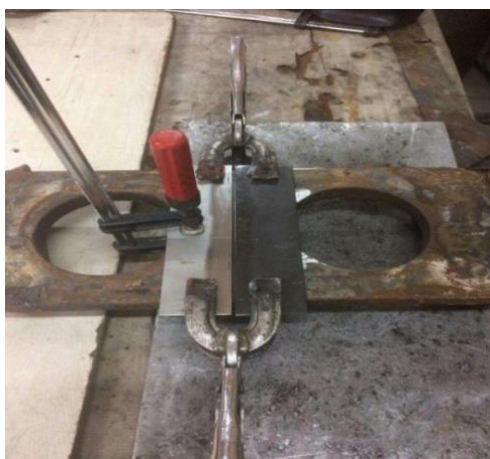
شکل ۲ نمایی از فیکسچر و قطعات فلزات پایه قبل از جوشکاری
