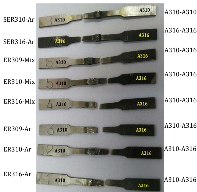
شکل ۱۰ نمونه‌های آزمون کشش پس از آزمون
