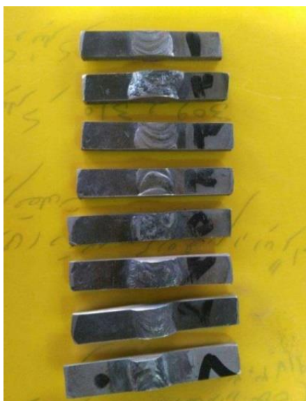
شکل ۴ نمایی از نمونه‌های آماده شده جهت انجام آزمون متالوگرافی
